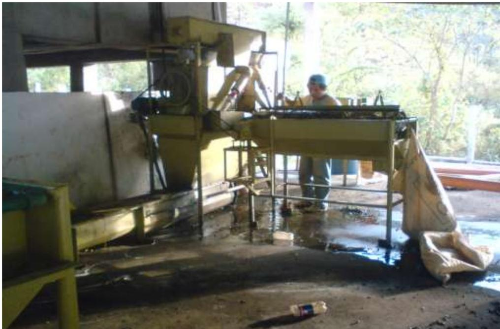
Vista lateral del despulpador, clasificación y encostalado del fruto no procesado por los pulperos
