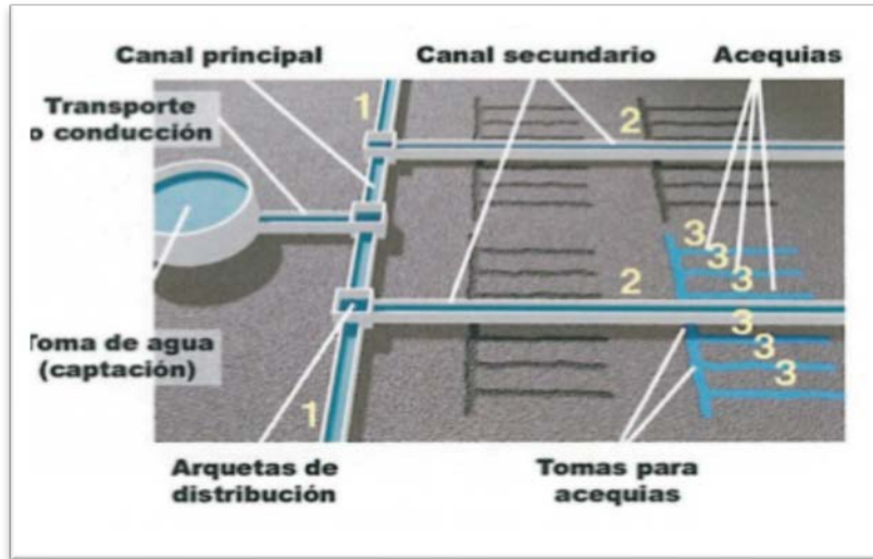
Figura No. 3 Esquema de una Red de Distribución Típica en un Riego por Superficie
