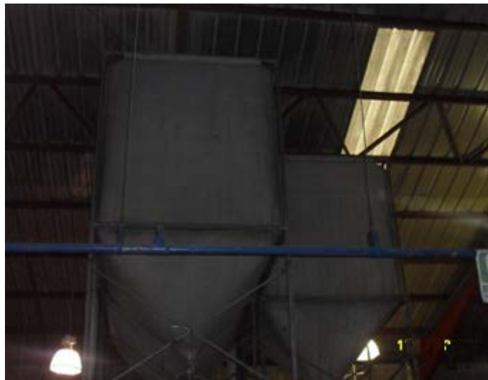
Grafica No 10 Silos que almacenan el poliestireno expandido
